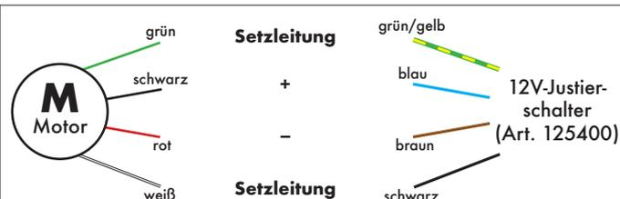
Abb.3: Anschluss am 12V-Justierschalter 125400 (Beispiel)
