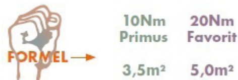
Abb.4: Faustformel zur Auswahl der Antriebsstärke
