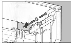
Die Abbildungen zeigen den generellen Montageablauf von Rolltoren. Abgebildet ist hier die Montage eines Rolltores mit einem 360mm-Kasten und Anrollkonsole. Auf der motorabge-
